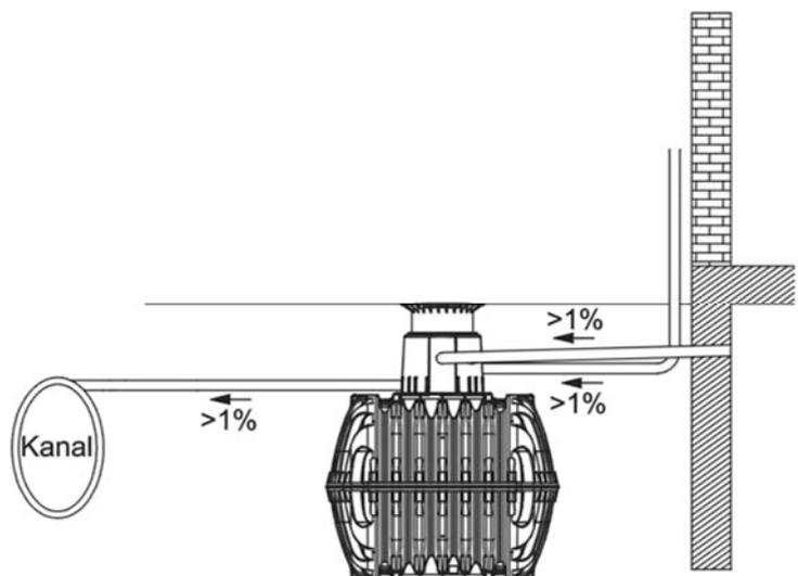
Anwendungsbestimmungen für Kleinkläranlagen nach DIN EN 12566-3 mit CE-Kennzeichnung: SBR-Anlagen Typ AQUAmax®, AQUAPRIMO® P; Ablaufklasse N
