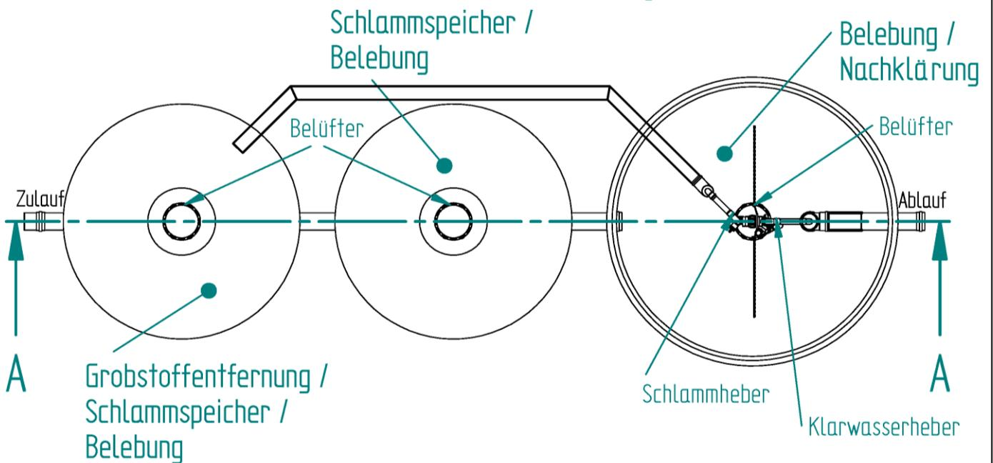
Alle Kammern können auch separate, in unterschiedlicher Form und Größe ausgebildete Behälter sein. Zu- und Abläufe der Nachrüstung sind der entsprechenden Ausführung anzupassen. Einzelne Kammern bzw. Behälter können, falls es sich aus der klärtechnischen Berechnung ergibt, stillgelegt werden. Auch andere Behältermaterialien in anderen Formen und Größen sind unter Einhaltung der Mindestvolumina nutzbar.
