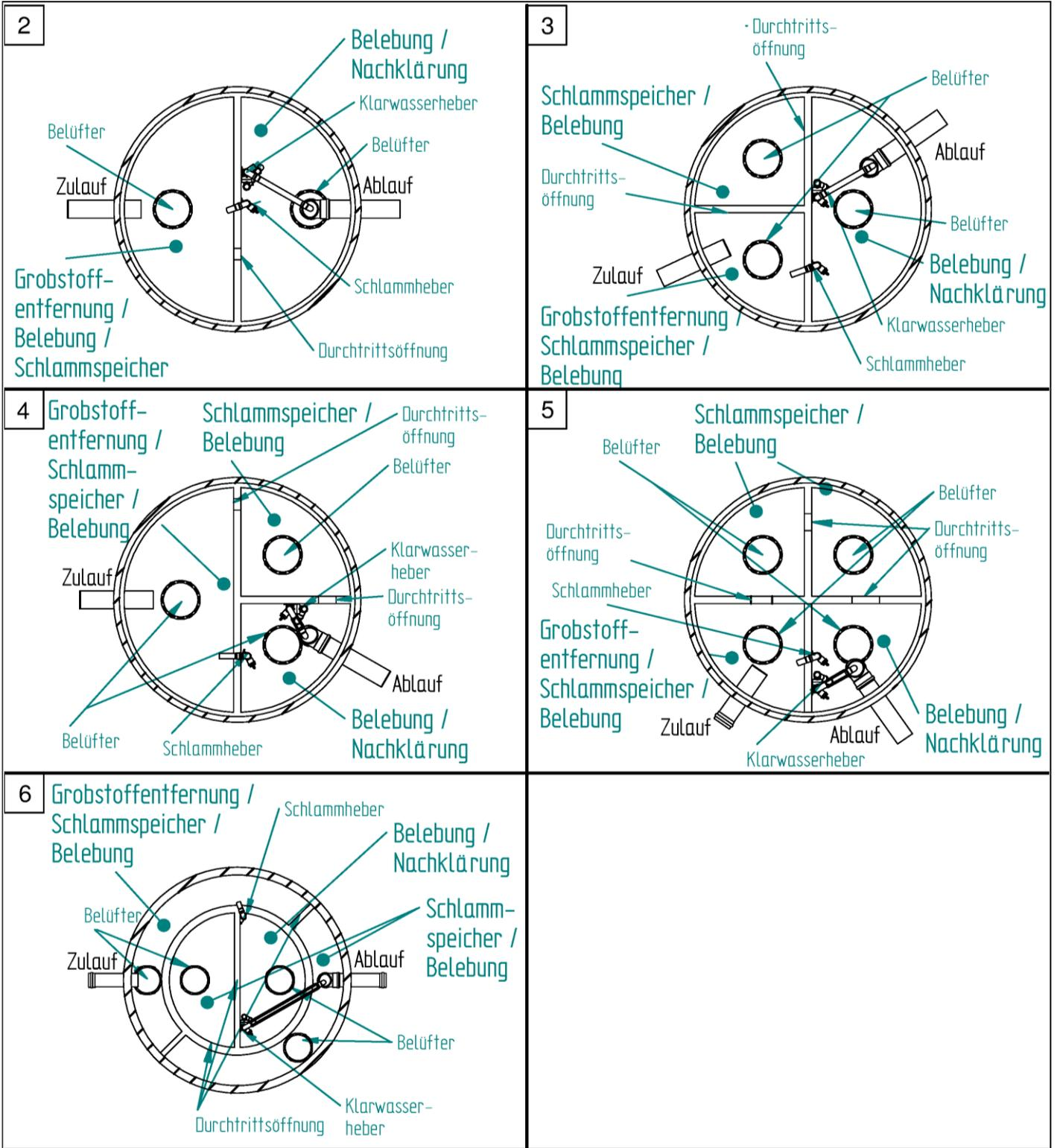
Alle Kammern können auch separate, in unterschiedlicher Form und Größe ausgebildete Behälter sein. Zu- und Abläufe der Nachrüstung sind der entsprechenden Ausführung anzupassen. Einzelne Kammern bzw. Behälter können, falls es sich aus der klärtechnischen Berechnung ergibt, stillgelegt werden. Auch andere Behältermaterialien in anderen Formen und Größen sind unter Einhaltung der Mindestvolumina nutzbar.
