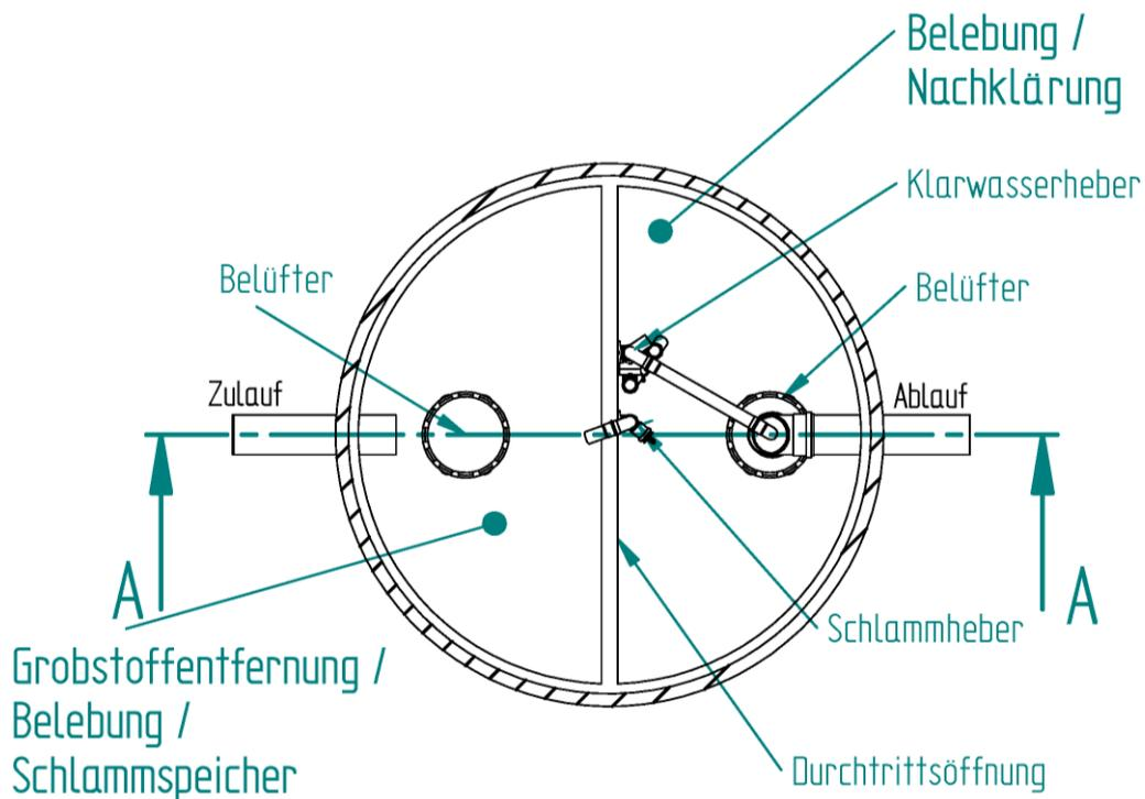
Alle Kammern können auch separate, in unterschiedlicher Form und Größe ausgebildete Behälter sein. Zu- und Abläufe der Nachrüstung sind der entsprechenden Ausführung anzupassen. Einzelne Kammern bzw. Behälter können, falls es sich aus der klärtechnischen Berechnung ergibt, stillgelegt werden. Auch andere Behältermaterialien in anderen Formen und Größen sind unter Einhaltung der Mindestvolumina nutzbar.
