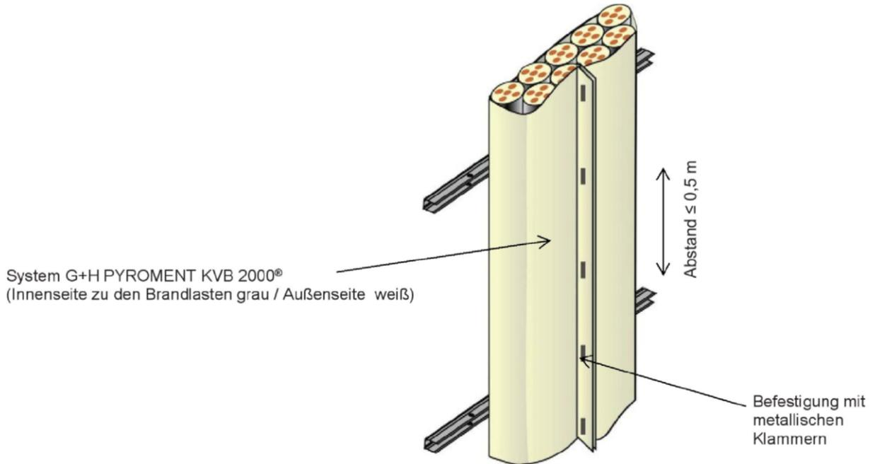
Verlegung Brandschutzgewebe, Befestigung mit Spannbändern oder Draht bei Steigetrassen
