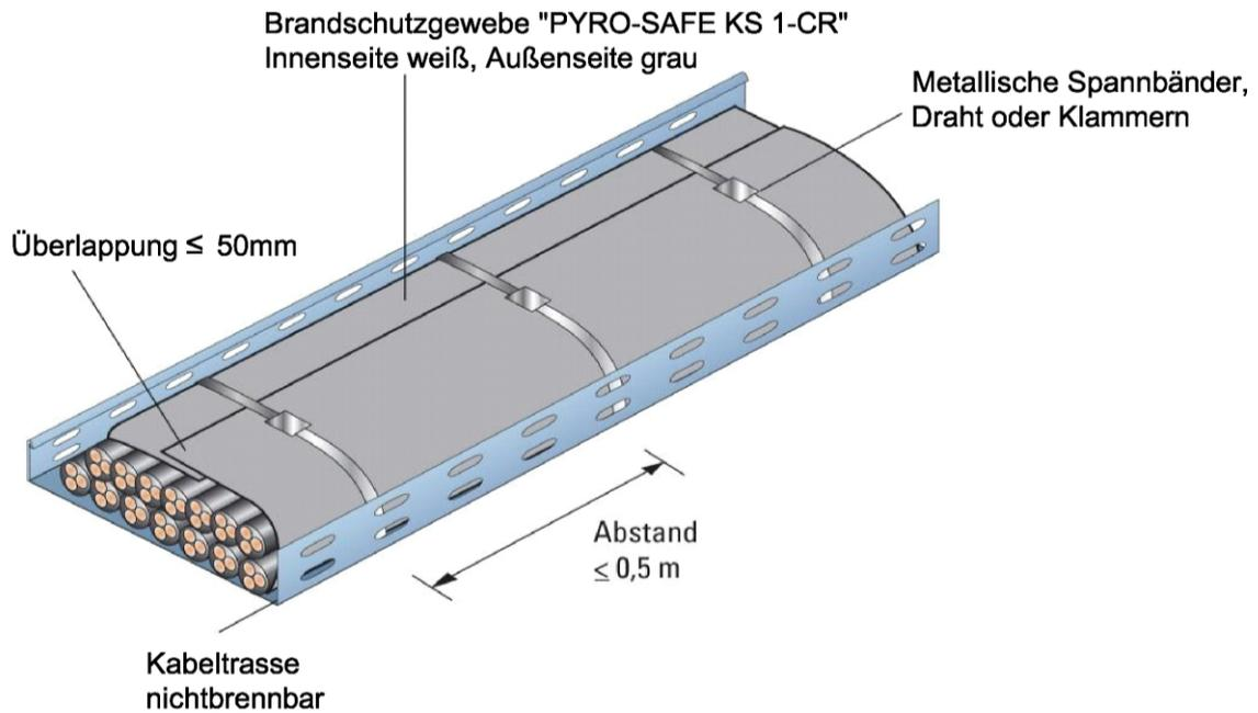
Bei Abstand zwischen dem Brandschutzgewebe "PYRO-SAFE KS1-CR und der Kabeloberfläche  $\leq 30$  mm und Verlegung um mehr als  $45^\circ$  aus der Horizontalen oder vertikal ist die Maßnahme "svt-S" nach Anlage 4 erforderlich.
