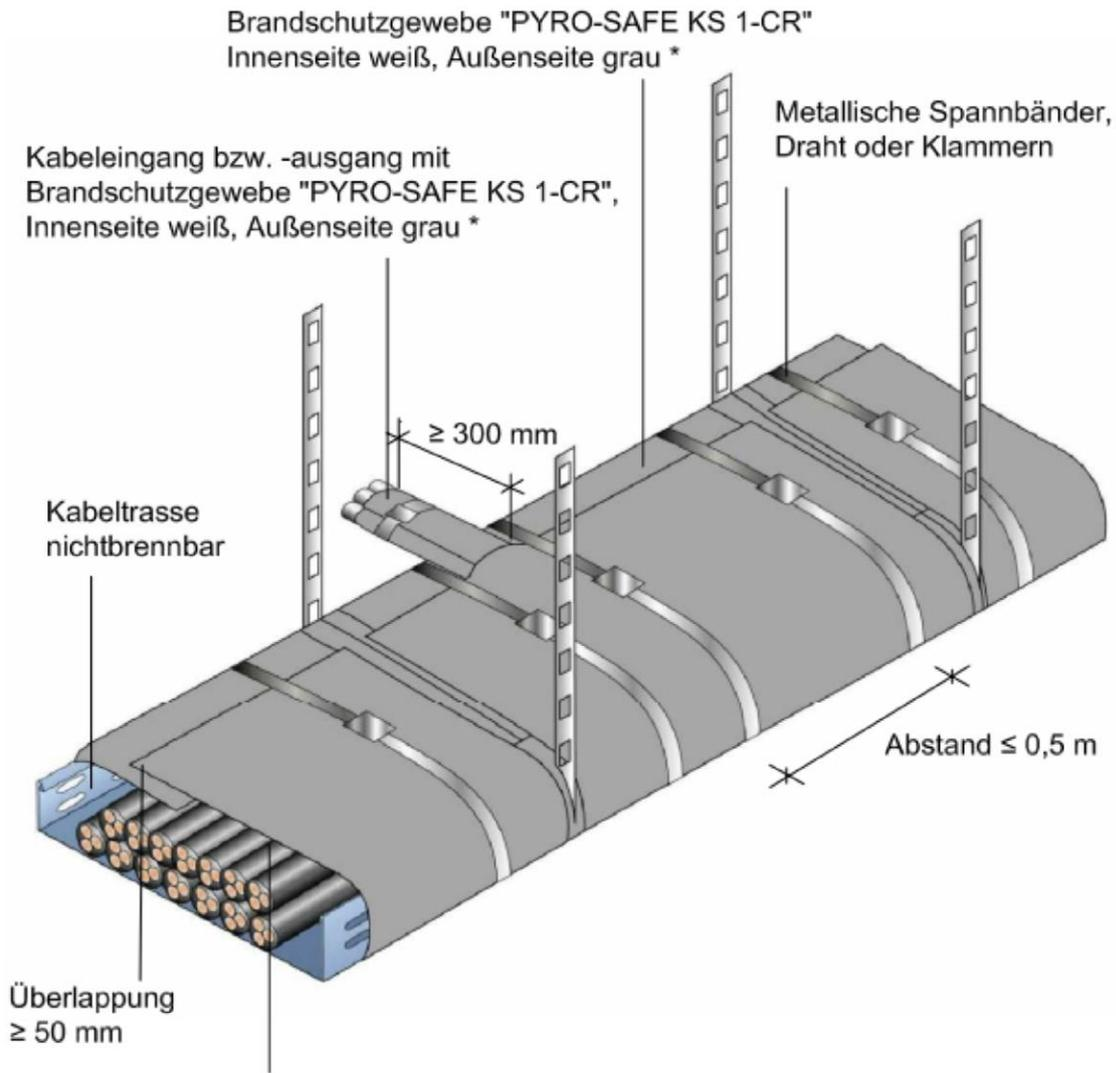
Abstand zwischen dem Brandschutzgewebe "PYRO-SAFE KS 1-CR" und der Kabeleingangsfläche  $\leq 30$  mm und Verlegung um mehr als  $45^\circ$  aus der Horizontalen oder vertikal - s. Abschnitt 4.1.5 und Anlage 4
