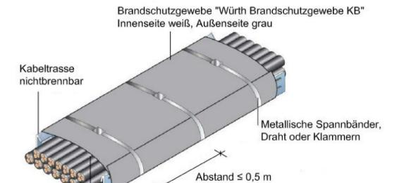
Bei Abstand zwischen dem Brandschutzgewebe "Würth Brandschutzgewebe KB" und der Kabeloberfläche ≤ 30 mm und Verlegung um mehr als 45° aus der Horizontalen oder vertikal ist Maßname "Würth S" nach Anlage 4 erforderlich
