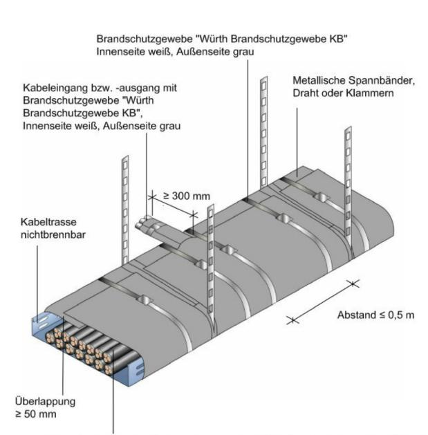
Abstand zwischen dem Brandschutzgewebe "Würth Brandschutzgewebe KB" und der Kabeloberfläche ≤ 30 mm und Verlegung um mehr als 45° aus der Horizontalen oder vertikal - s. Abschnitt 4.1.5 und Anlage 4
