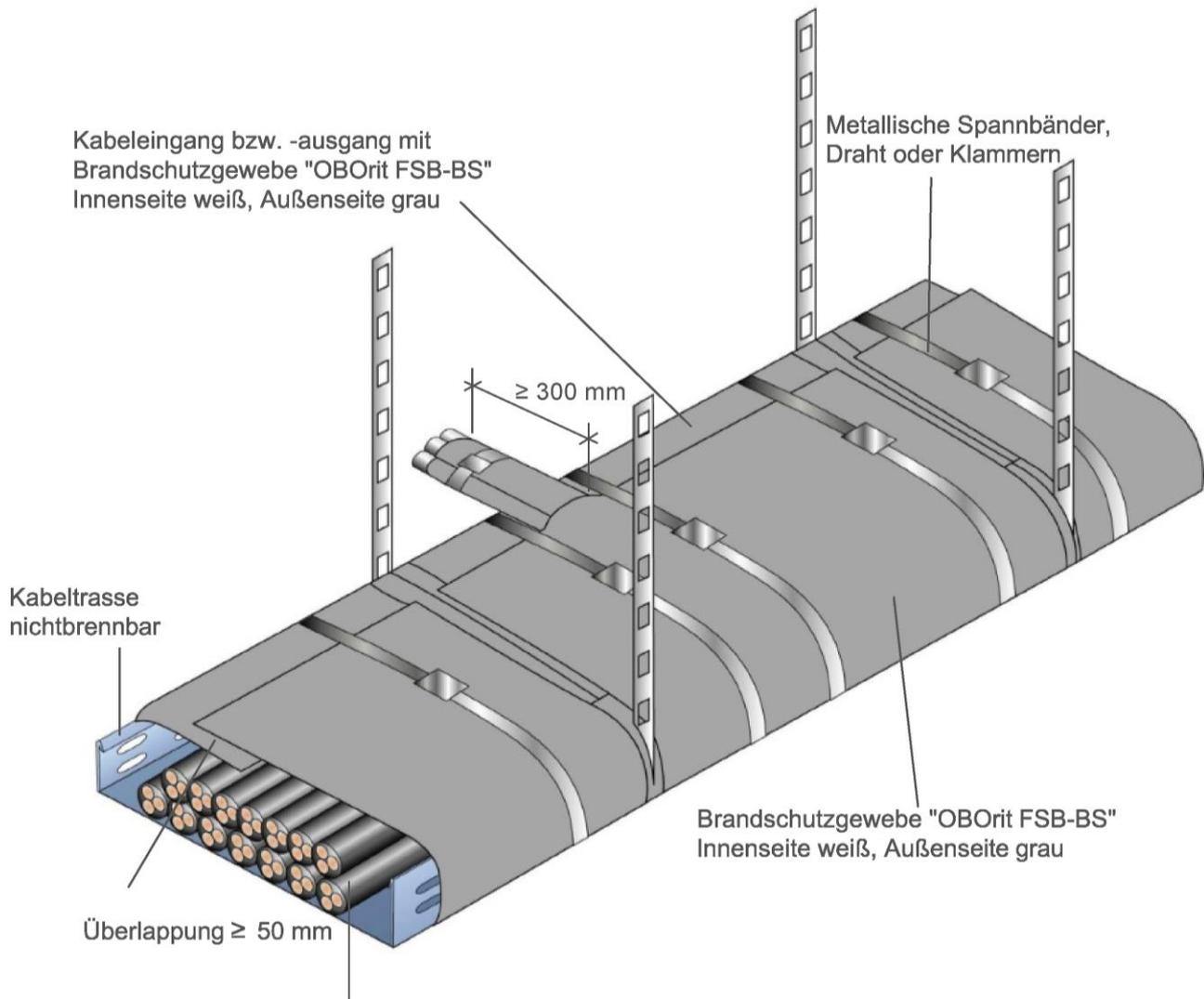
Abstand zwischen dem Brandschutzgewebe "OBOrit FSB-BS" und der Kabeloberfläche  $\leq 30$  mm und Verlegung um mehr als  $45^\circ$  aus der Horizontalen oder vertikal - s. Abschnitt 4.1.5 und Anlage 4
