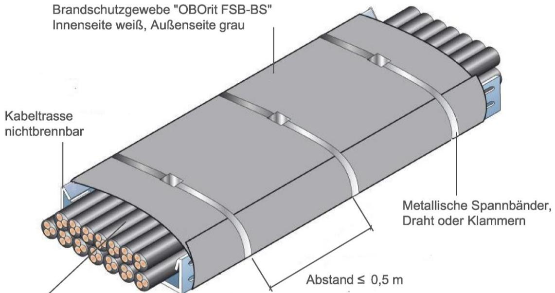
Bei Abstand zwischen dem Brandschutzgewebe "OBOrit FSB-BS" und der Kabeloberfläche  $\leq 30$  mm und Verlegung um mehr als  $45^\circ$  aus der Horizontalen oder vertikal ist die Maßnahme "S-förmige Hinterlegung" nach Anlage 4 erforderlich
