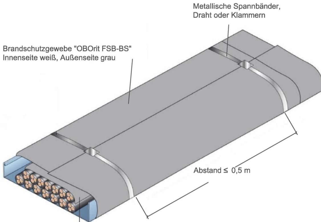
Zwischenlage als Abdeckung der oberen Kabellage:
