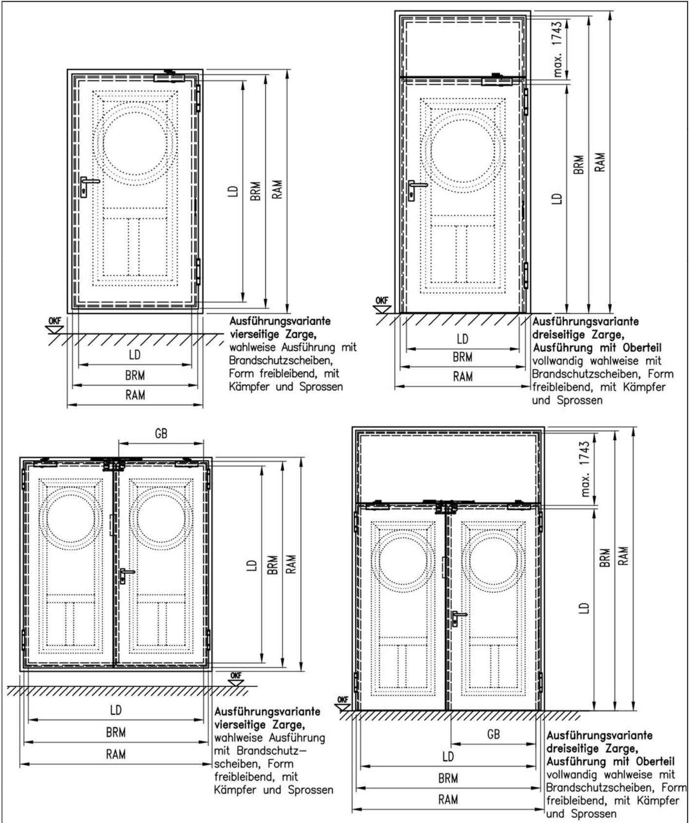
T 90-1-FSA "System SOMMER - S1" bzw. T 90-1-RS-FSA "System SOMMER - S1" bzw.
