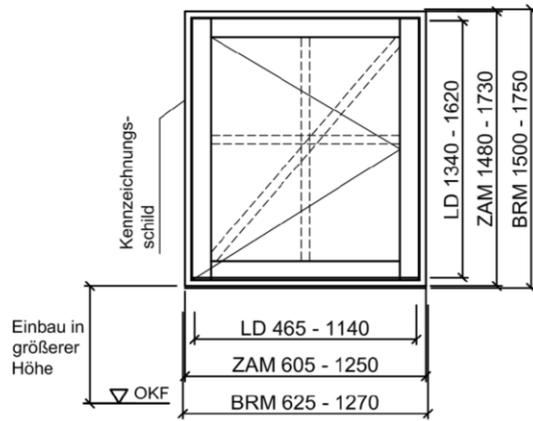
Die T 30-1-RS-Tür und T30-2-RS-Tür immer mit absenkbarer Bodendichtung oder 4-seitiger Zarge mit Dichtung ausführen und den Wandanschluss immer versiegeln!
