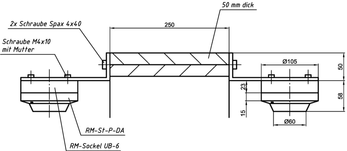
*Rauchmelder Befestigung/Einbau/Verbund mit Absperrvorrichtung "BKI-EI90S"*
