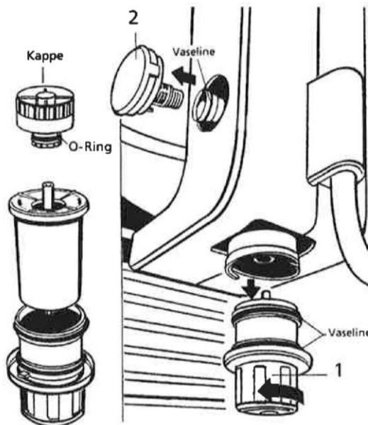
Leuchtet Amalgam am Bedien- und Anzeigeelement auf, ist der gefüllte Rotor wie folgt zu tauschen:
