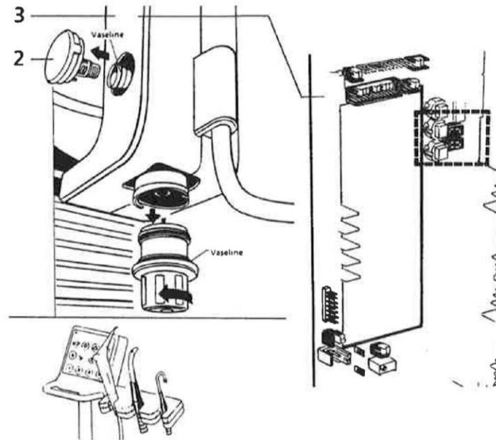
Filter (2) abziehen, Verkleidung (3) abschrauben, Filter wieder aufstecken.
