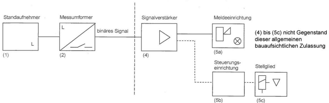
Standaufnehmer (Schwimmerprinzip) mit eingebautem Messumformer als Teil von Überfüllsicherungen
