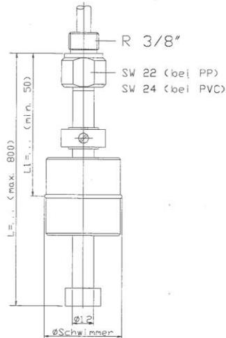
Schema Überfüllsicherung mit Schwimmer-Magnetschalter (Standgrenzschalter)
