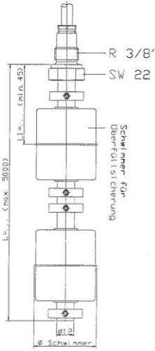
Magnet-Schwimmerschalter mit Anschlussgehäuse
