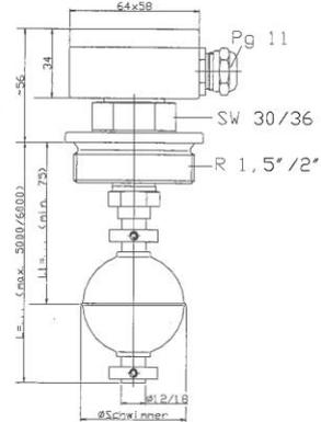
Magnet-Schwimmerschalter mit Anschlussgehäuse
