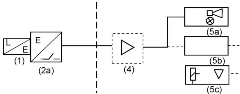
Schema der Überfüllsicherung für Meßumformer FEL55, FEL56 und FEL58
