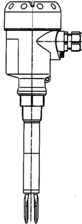
**Schema der Überfüllsicherung**
