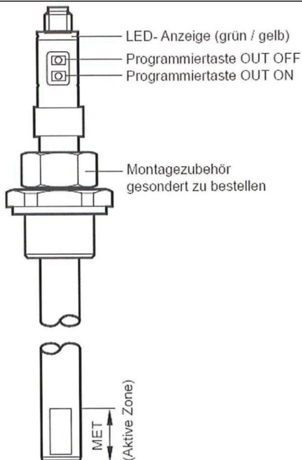
**Schema der Überfüllsicherung**
