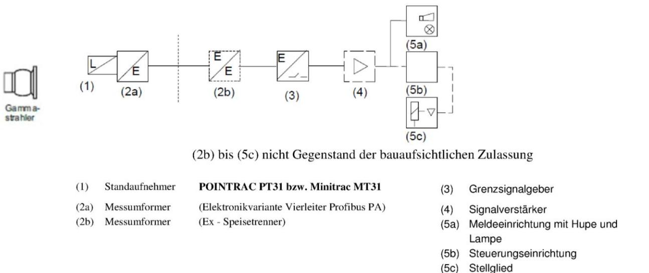
Standgrenzschalter "PROTRAC" mit den Standaufnehmern (Szintillationsdetektor) "MINITRAC" Typ MT31... und "POINTRAC" Typ PT31... als Teile von Überfüllsicherungen
