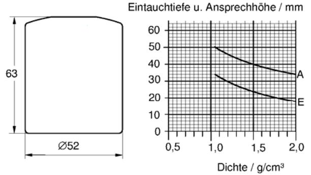
**Schwimmer Typ PE-52 L, Dichte  $\geq 0.8$  g/cm<sup>3</sup>**
