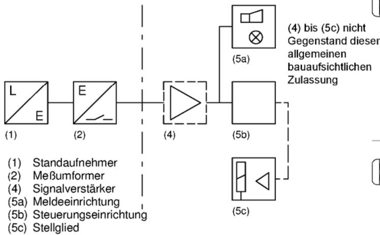
Leckagesonde (Schwimmer) Typ "T200L" und Messumformer als Teile von Leckageerkennungssystemen
