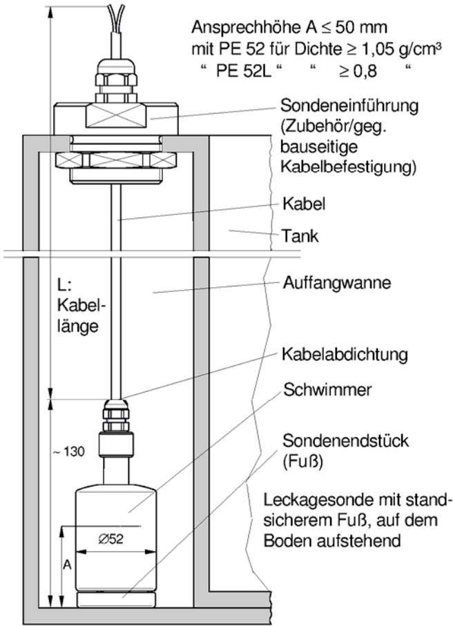
**Schwimmer Typ PE-52, Dichte  $\geq 1.05$  g/cm<sup>3</sup>**
