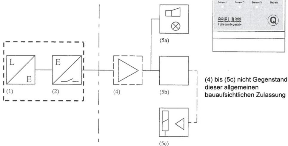
Leckagesonde (Kapazitive Sonde) "KL25..." mit integriertem Messumformer als Teile von Leckagerkennungssystemen
