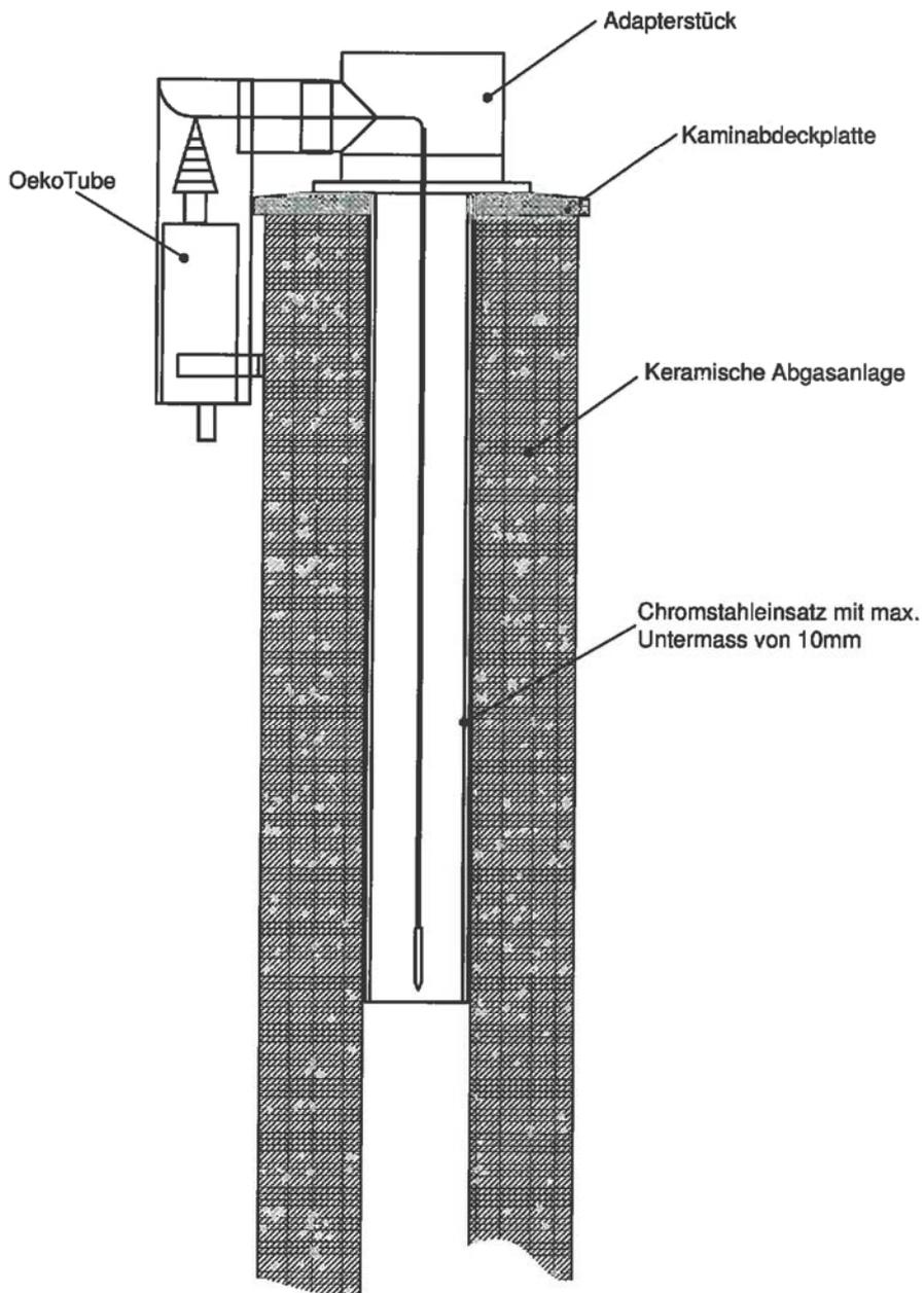
Staubabscheider für Abgasanlagen,
