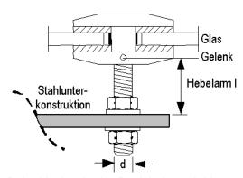
Beim Nachweis der Punkthalter mit Verguss darf eine mittlere Lochleibungsdruckspannung von 10 MPa für HILTI HIT HY 70 Injektionsmörtel nicht überschritten werden.
