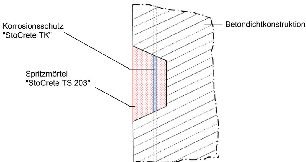
StoCrete TS 203 kunststoffmodifizierter Zement-Spritzmörtel als Bestandteil des "SPCC Betonersatzsystems StoCrete TS 203" der StoCretec GmbH zur Instandsetzung in LAU-Anlagen
