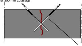
Stahlpacker, Außendurchmesser 10 mm bis 14 mm mit Kegel- oder Flachkopfnippel
