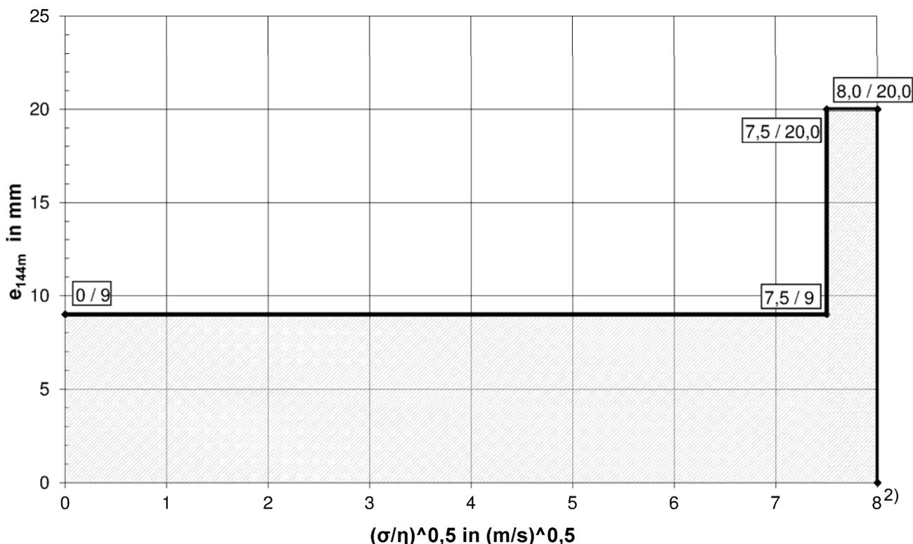
**Abbildung 1:** Eindringverhalten (mittlere Eindringtiefe  $e_{144m}$  von Flüssigkeiten)<sup>1)</sup>, aufgrund der jeweiligen dynamischen Viskosität  $\eta$  und Oberflächenspannung  $\sigma$
