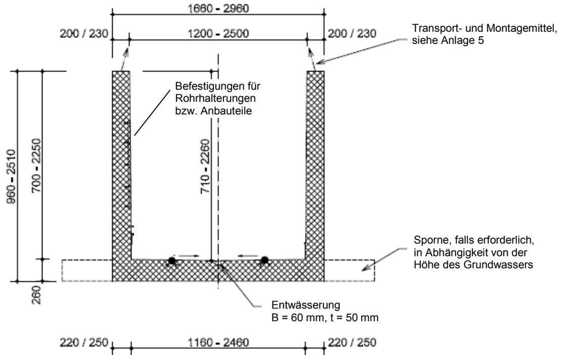
**Trog-Element, Typ 1.2, Pumpensumpf-Element:**
