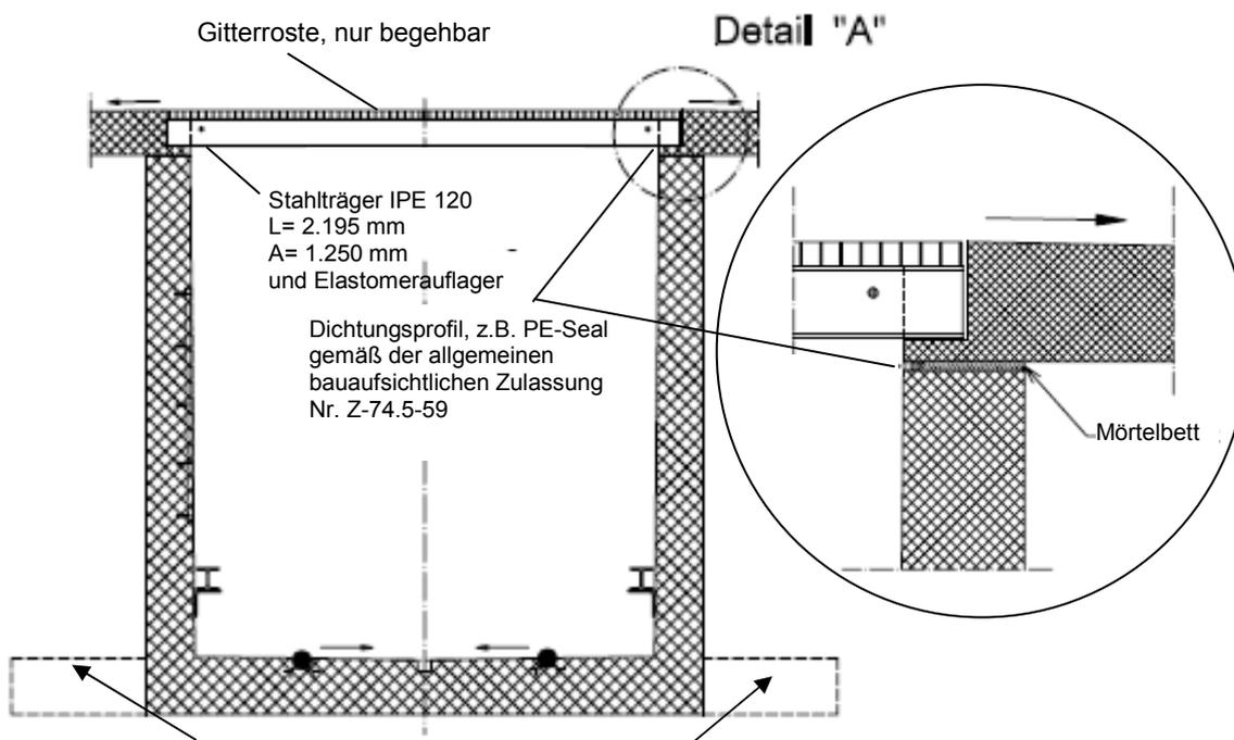
Beide Sporne (falls erforderlich, in Abhängigkeit von der Höhe des Grundwassers) werden auf der Baustelle hergestellt
