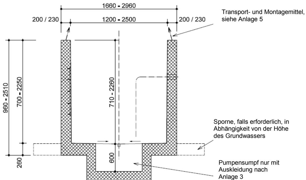
B+F Abdichtungssystem aus Trogelementen, Ableitflächen und Sammelschächten zur Verwendung in LAU-Anlagen
