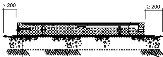
zul. Bodenpressung:  $\text{zul. } \sigma_0 \geq 250 \text{ kN/m}^2$
