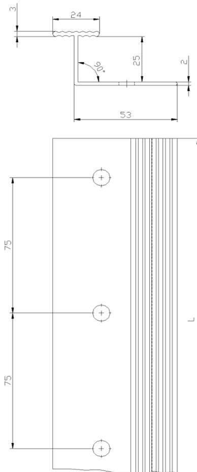
**Vertikales Verbindungsprofil "PVC Verbindungsleiste BM 400" (Maße in mm)**
