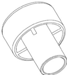
**Verfüllstutzen für Überkopf- oder Horizontalmontage**
