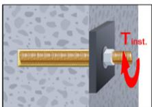
10. Nach vollständiger Aushärtung kann das Anbauteil mit dem zulässigen Drehmoment (Tabelle B2) montiert werden. Die Mutter muss mit einem geeigneten Drehmomentschlüssel festgezogen werden.
