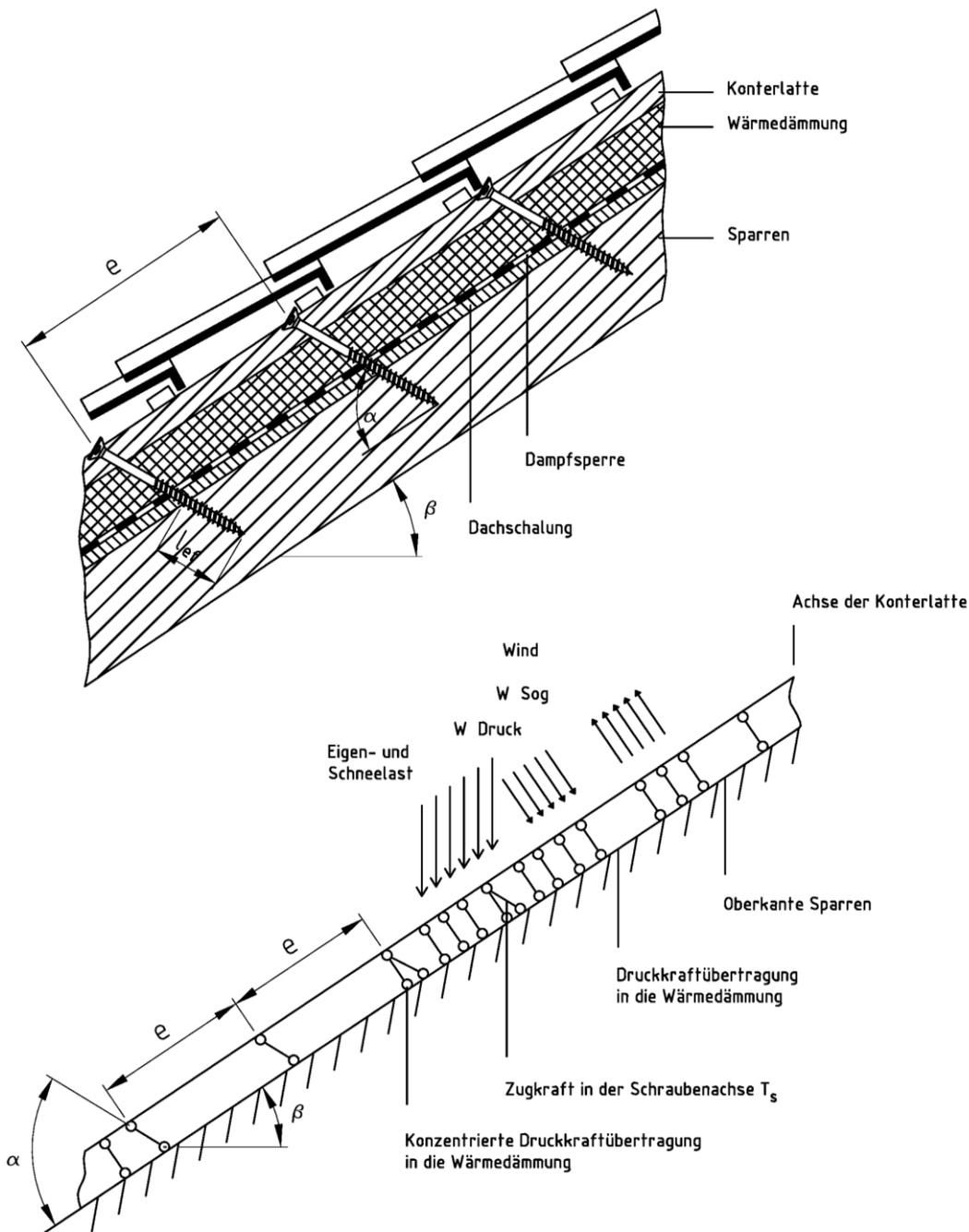
Abbildung 3.1: Befestigung von Aufdach-Dämmsystemen auf Sparren- Statisches Modell
