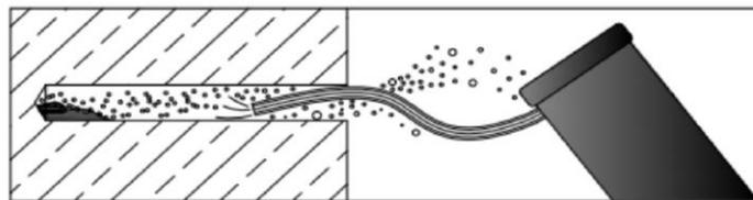
2. Bohrloch reinigen
