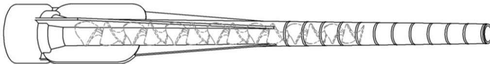
Mungo Injektionssystem MIT-SE Plus oder MIT-COOL Plus für Mauerwerk
