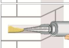
5. Das Bohrloch vom Grund her zu mindestens 2/3 mit Mörtel füllen. Langsames Zurückziehen des Statikmischer aus dem Bohrloch verhindert die Bildung von Luftschlüssen. Die temperaturrelevanten Verarbeitungszeiten (Tabelle B4 und B5) sind zu beachten.
