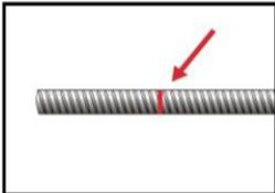
3b. Vor dem Injizieren des Mörtels ist die Setztiefe auf dem Bewehrungsstab markieren (z.B. mit Klebeband). Danach den Bewehrungsstab in das leere Bohrloch einführen, um die korrekte Bohrlochtiefe  $l_v$  zu überprüfen.
