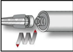
3a. Den mitgelieferten Statikmischer fest auf die Kartusche aufschrauben und Kartusche in eine geeignete Auspresspistole einlegen.
