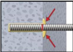
5b. Nach Installation des Ankers sicherstellen, dass sich die Setztiefenmarkierung an der Bohrlochoberfläche befindet und der Ringspalt komplett mit Mörtel ausgefüllt ist. Tritt keine Masse nach Erreichen der Setztiefe heraus, ist diese Voraussetzung nicht erfüllt und die Anwendung muss vor Beendigung der Verarbeitungszeit wiederholt werden. Bei Überkopfmontage ist der Bewehrungsstab zu fixieren (z.B. Holzkeile).
