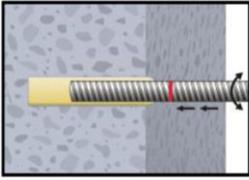
5a. Bewehrungsstab mit leichter Drehbewegung (zur Verbesserung der Mörtelverteilung) bis zur Setztiefenmarkierung in das Bohrloch einführen
