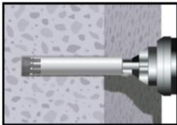
1. Bohrloch mit dem Bohrdurchmesser gemäß Tabelle B5 und der Bohrtiefe entsprechend des gewählten Bewehrungsseisens mit Hammerbohrer (HD), Druckluftbohrer (CD) oder Diamantbohrer (DD) in den Untergrund bohren. Bei Fehlbohrungen ist das Bohrloch zu vermörteln.
