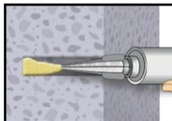
4. Gereinigtes Bohrloch vom Bohrlochgrund her ca. zu 2/3 mit Verbundmörtel befüllen. Langsames Zurückziehen des Statikmischers aus dem Bohrloch verhindert die Bildung von Lufteinschlüssen. Für Setztiefen größer 190 mm passende Mischerverlängerung verwenden.
