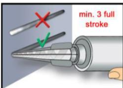
3c. Der Mörtelvorlauf ist nicht zur Befestigung des Bewehrungsstabs geeignet. Daher Vorlauf solange verwerfen, bis sich eine gleichmäßig graue oder rote Mischfarbe eingestellt hat, jedoch min. 3 volle Hübe.
