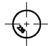
Prägung des Spezialnagels: Länge des Nagels (e.g. 235)
