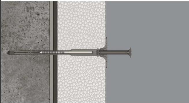
Dübel in das Bohrloch einsetzen.
