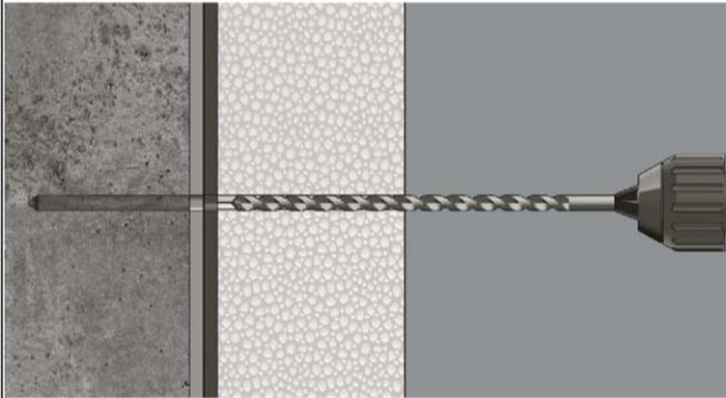
Bohrloch senkrecht zur Oberfläche
