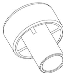
**Verfüllstutzen für Überkopf- oder Horizontalmontage**
