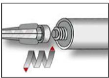
3. Den mitgelieferten Statikmischer fest auf die Kartusche aufschrauben und Kartusche in eine geeignete Auspresspistole einlegen. Den Schlauchfolienclip vor der Verwendung abschneiden. Bei jeder Arbeitsunterbrechung länger als die empfohlene Verarbeitungszeit (Tabelle B3) und bei jeder neuen Kartusche ist der Statikmischer zu erneuern.
