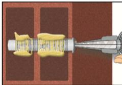
6. Die Siebhülse vom Grund her mit Mörtel füllen. Die exakte Mörtelmenge ist dem Kartuschenetikett oder der Montageanleitung zu entnehmen. Die temperaturrelevanten Verarbeitungszeiten (Tabelle B4 und B5) sind zu beachten
