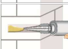
5. Das Bohrloch vom Grund her zu mindestens 2/3 mit Mörtel füllen. Langsames Zurückziehen des Statikmischer aus dem Bohrloch verhindert die Bildung von Luftschlüssen. Die temperaturrelevanten Verarbeitungszeiten (Tabelle B4 und B5) sind zu beachten.
