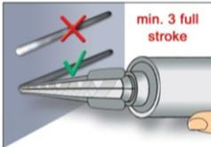
2. Der Mörtelvorlauf ist nicht zur Befestigung der Ankerstange geeignet. Vor dem Injizieren ins Bohrloch, unvermischten Mörtel solange verwerfen, bis sich eine gleichmäßige graue Mischfarbe eingestellt hat, jedoch mindesten 3 volle Hübe, bei Schlauchfolien 6 volle Hübe.
