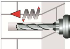
3. Das Bohrloch, senkrecht zur Oberfläche des Verankerungsgrundes, unter Verwendung eines Hartmetallbohrers mit Bohrverfahren nach Anhang C4-C45, mit vorgeschriebenem Bohrerinnendurchmesser und Bohrlochtiefe entsprechend der Ankergröße und Einbindetiefe des gewählten Dübels, im Verankerungsgrund erstellen. Bei Fehlbohrungen ist das Bohrloch zu vermörteln.
