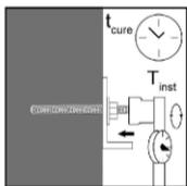
10. Nach vollständiger Aushärtung kann das Anbauteil mit dem zulässigen Drehmoment (Tabelle B1) montiert werden. Die Mutter muss mit einem geeignetem Drehmomentschlüssel festgezogen werden.
