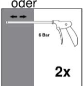
**Nach der Reinigung ist das Bohrloch bis zum Injizieren des Mörtels vor erneutem Verschmutzen in einer geeigneten Weise zu schützen. Ggf. ist die Reinigung unmittelbar vor dem Injizieren des Mörtels zu wiederholen. Einfließendes Wasser darf nicht zur erneuten Verschmutzung des Bohrloches führen.**
