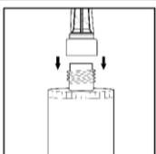
3. Den mitgelieferten Statikmischer fest auf die Kartusche aufschrauben und Kartusche in eine geeignete Auspresspistole einlegen. Bei jeder Arbeitsunterbrechung länger als die empfohlene Verarbeitungszeit (Tabelle B3) und bei jeder neuen Kartusche ist der Statikmischer zu erneuern.
