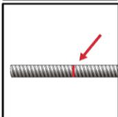
4. Vor dem Injizieren des Mörtels die geforderte Setztiefe auf der Ankerstange markieren.
