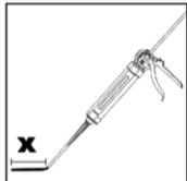
5. Der Mörtelvorlauf ist nicht zur Befestigung der Ankerstange geeignet. Daher Vorlauf solange verwerfen, bis sich eine gleichmäßig graue Mischfarbe eingestellt hat, jedoch min. 3 volle Hübe.
