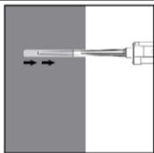
6. Gereinigtes Bohrloch vom Bohrlochgrund her ca. zu 2/3 mit Verbundmörtel befüllen. Langsames Zurückziehen des Statikmischers aus dem Bohrloch verhindert die Bildung von Lufteinschlüssen. Für Verankerungstiefen > 190 mm passende Mischerverlängerung verwenden. Für die Horizontal- oder Überkopfmontage von Ankern > Ø 20 mm sind Verfüllstutzen gemäß Anhang B 5 zu verwenden. Die temperaturrelevanten Verarbeitungszeiten (Tabelle B3) sind zu beachten.
