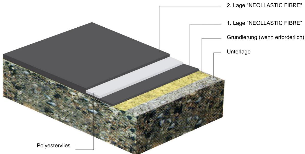
Für die Dachabdichtung "NEOLLASTIC FIBRE" gilt:
