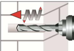
3. Bohrloch (ohne Hammerschlag) mit Bohrerdurchmesser und Bohrlochtiefe entsprechend der Ankergröße und Einbindetiefe des gewählten Dübels im Verankerungsgrund erstellen. Bei Fehlbohrungen ist das Bohrloch zu vermörteln.
