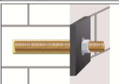
9. Nach vollständiger Aushärtung kann das Anbauteil mit dem maximalen Drehmoment (Tabelle B1 oder B2) montiert werden. Die Mutter muss mit einem geeichten Drehmomentschlüssel festgezogen werden.
