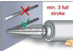
2. Kartusche in eine geeignete Auspresspistole einlegen. Vor dem Injizieren des Mörtels ins Bohrloch ist der Vorlauf zu kontrollieren und zu verwerfen, bis der Mörtel eine einheitlich graue Mischfarbe aufweist, jedoch mindestens drei volle Hübe.
