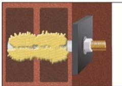
9. Nach vollständiger Aushärtung kann das Anbauteil mit dem maximalen Drehmoment (Tabelle B2) montiert werden. Die Mutter muss mit einem geeichten Drehmomentschlüssel festgezogen werden.
