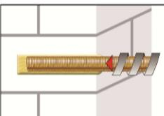
6. Vor dem Einsetzen der Ankerstange ist die Setztiefe auf der Ankerstange zu markieren. Befestigungselement mit leichten Drehbewegungen, zur optimalen Verteilung des Mörtels, bis zur festgelegten Setztiefe einführen. Die Ankerstange sollte fett-, öl- und schmutzfrei sein.
