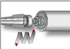
1. Den mitgelieferten Statikmischer auf die Kartusche aufschrauben und Kartusche in eine geeignete Auspresspistole einlegen. Den Schlauchfolienclip vor der Verwendung abschneiden. Bei jeder Arbeitsunterbrechung länger als die empfohlene Verarbeitungszeit (Tabelle B3) und bei jeder Kartusche ist der Statikmischer zu erneuern.
