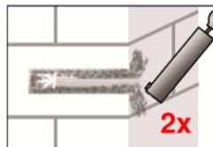
4. Bohrloch vom Bohrlochgrund her zweimal ausblasen, anschließend zweimal bürsten und abschließend erneut zweimal ausblasen.
