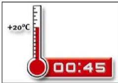
8. Die angegebene Aushärtezeit muss eingehalten werden. Der Anker darf vor Erreichen der Aushärtezeit (Tabelle B3) nicht bewegt oder belastet werden.
