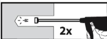
**Nach der Reinigung ist das Bohrloch bis zum Injizieren des Mörtels vor erneutem Verschmutzen in einer geeigneten Weise zu schützen. Ggf. ist die Reinigung unmittelbar vor dem Injizieren des Mörtels zu wiederholen. Einfließendes Wasser darf nicht zur erneuten Verschmutzung des Bohrloches führen.**
