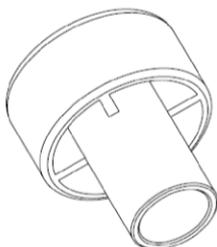
**Verfüllstutzen für Überkopf- oder Horizontalmontage**
