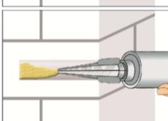
5. Das Bohrloch vom Grund her zu mindestens 2/3 mit Mörtel füllen. Langsames Zurückziehen des Statikmischers aus dem Bohrloch verhindert die Bildung von Luft einschlüssen. Die temperaturrelevanten Verarbeitungszeiten (Tabelle B4 und B5) sind zu beachten.
