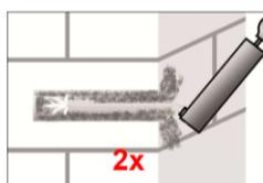
4. Bohrloch vom Bohrlochgrund her zweimal ausblasen. Die Stahlbürste mit passender Größe ( $> d_{b,min}$  Tabelle B2 oder B3) an einer Bohrmaschine oder einen Akkuschauber einstecken, das Bohrloch zweimal bürsten und abschließend erneut zweimal ausblasen.
