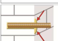
7. Nach der Installation des Ankers sollte der Ringspalt komplett mit Mörtel ausgefüllt sein. Tritt keine Masse nach Erreichen der Verankerungstiefe heraus, ist diese Voraussetzung nicht erfüllt und die Anwendung muss vor Beendigung der Verarbeitungszeit wiederholt werden.
