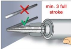
2. Der Mörtelvorlauf ist nicht zur Befestigung der Ankerstange geeignet. Vor dem Injizieren ins Bohrloch, unvermischten Mörtel solange verwerfen, bis sich eine gleichmäßige graue Mischfarbe eingestellt hat, jedoch mindestens 3 volle Hübe, bei Schlauchfolien 6 volle Hübe.
