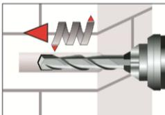
3. Das Bohrloch, senkrecht zur Oberfläche des Verankerungsgrundes, unter Verwendung eines Hartmetallbohrers mit Bohrverfahren nach Anhang C4-C45, mit vorgeschriebenem Bohrerennendurchmesser und Bohrlochtiefe entsprechend der Ankergröße und Einbindetiefe des gewählten Dübels, im Verankerungsgrund erstellen. Bei Fehlbohrungen ist das Bohrloch zu vermörteln.
