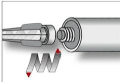
1. Die Kappe von der Kartusche entfernen und den mitgelieferten Statikmischer fest auf die Kartusche aufschrauben und Kartusche in eine geeignete Auspresspistole einlegen. Bei Schlauchfolien den Clip vor der Verwendung abschneiden. Bei jeder Arbeitsunterbrechung länger als die empfohlene Verarbeitungszeit (Tabelle B4 und B5) und bei jeder neuen Kartusche ist der Statikmischer zu erneuern.
