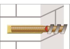
6. Vor dem Einsetzen der Ankerstange ist die Verankerungstiefe auf der Ankerstange zu markieren. Befestigungselement mit leichten Drehbewegungen bis zur festgelegten Setztiefe eindrücken. Die Ankerstange muss schmutz-, fett-, und ölfrei sein.
