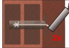
4. Bohrloch vom Bohrlochgrund her zweimal ausblasen. Die Stahlbürste an einer Bohrmaschine oder einen Akkuschauber einstecken, das Bohrloch zweimal bürsten und abschließend erneut zweimal ausblasen.
