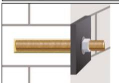
9. Nach vollständiger Aushärtung kann das Anbauteil mit bis zu dem maximalen Installationsdrehmoment (siehe Anhang C4-C45) montiert werden. Die Mutter muss mit einem kalibrierten Drehmomentschlüssel angezogen werden.
