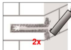
4. Bohrloch vom Bohrlochgrund her zweimal ausblasen. Die Stahlbürste an einer Bohrmaschine oder einen Akkuschrauber einstecken, das Bohrloch zweimal bürsten und abschließend erneut zweimal ausblasen.
