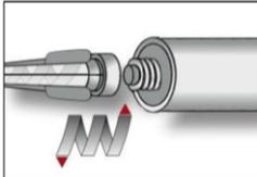
1. Die Kappe von der Kartusche entfernen und den mitgelieferten Statikmischer fest auf die Kartusche aufschrauben und Kartusche in eine geeignete Auspresspistole einlegen. Bei Schlauchfolien den Clip vor der Verwendung abschneiden. Bei jeder Arbeitsunterbrechung länger als die empfohlene Verarbeitungszeit (Tabelle B4) und bei jeder neuen Kartusche ist der Statikmischer zu erneuern.
