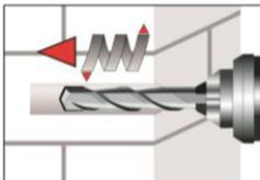
3. Das Bohrloch, senkrecht zur Oberfläche des Verankerungsgrundes, unter Verwendung eines Hartmetallbohrers mit Bohrverfahren nach Anhang C4-C45, mit vorgeschriebenem Bohrernennendurchmesser und Bohrlochtiefe entsprechend der Ankergröße und Einbindetiefe des gewählten Dübels, im Verankerungsgrund erstellen. Bei Fehlbohrungen ist das Bohrloch zu vermörteln.
