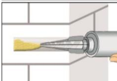
5. Das Bohrloch vom Grund her zu mindestens 2/3 mit Mörtel füllen. Langsames Zurückziehen des Statikmischers aus dem Bohrloch verhindert die Bildung von Luftpfehlern. Die temperaturrelevanten Verarbeitungszeiten (Tabelle B4) sind zu beachten.
