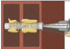
6. Die Siebhülse vom Grund her mit Mörtel füllen. Die exakte Mörtelmenge ist dem Kartuschenetikett oder der Montageanleitung zu entnehmen. Die temperaturrelevanten Verarbeitungszeiten (Tabelle B4) sind zu beachten
