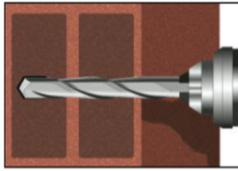
3. Das Bohrloch, senkrecht zur Oberfläche des Verankerungsgrundes, mit Bohrverfahren nach Anhang C4-C45, mit vorgeschriebenem Bohrerenddurchmesser und Bohrlochtiefe entsprechend der Ankergröße und Einbindetiefe des gewählten Dübels, im Verankerungsgrund erstellen.
