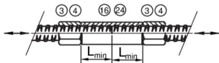
Bild 7 Muffenstoß - Sechskantmuffe, lang Ø12 - 50
