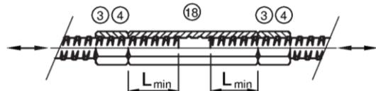
Bild 8 Muffenstoß - Reduziermuffe, rund Ø12 - 50
