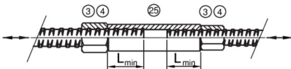
Bild 10 Muffenstoß - Spanschloß Ø12 - 50
