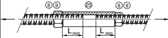
Bild 5 Muffenstoß - Spanschloß Ø12 - 50
