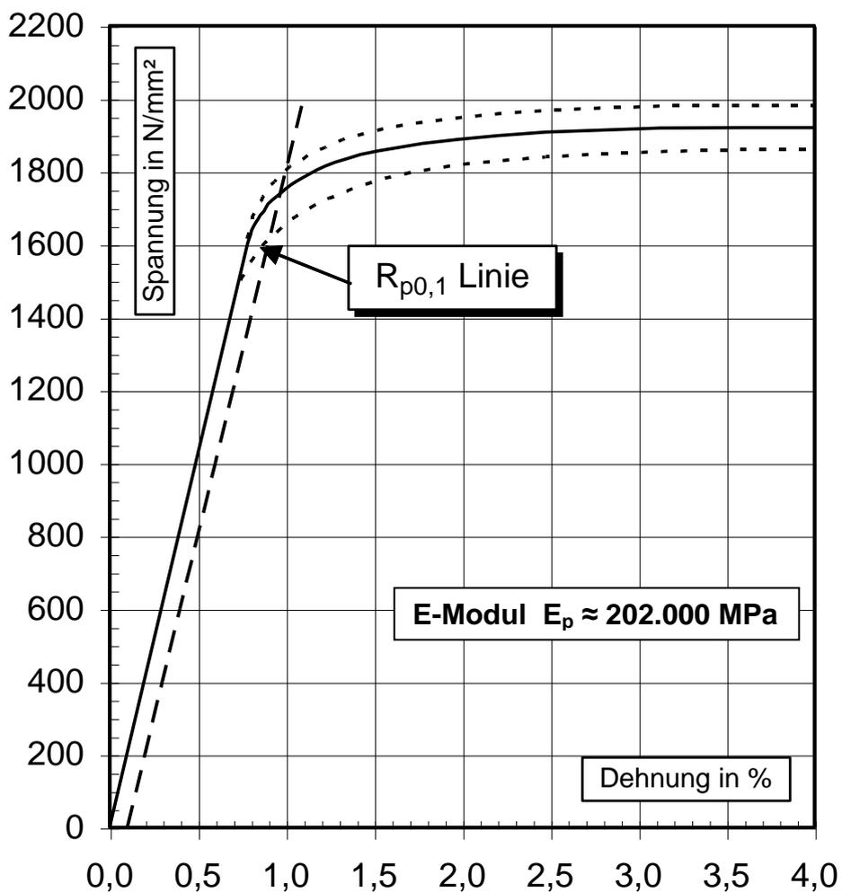
Die gestrichelten Linien markieren den Bereich, innerhalb dessen die tatsächlichen Spannungs - Dehnungslinie auftreten kann.
