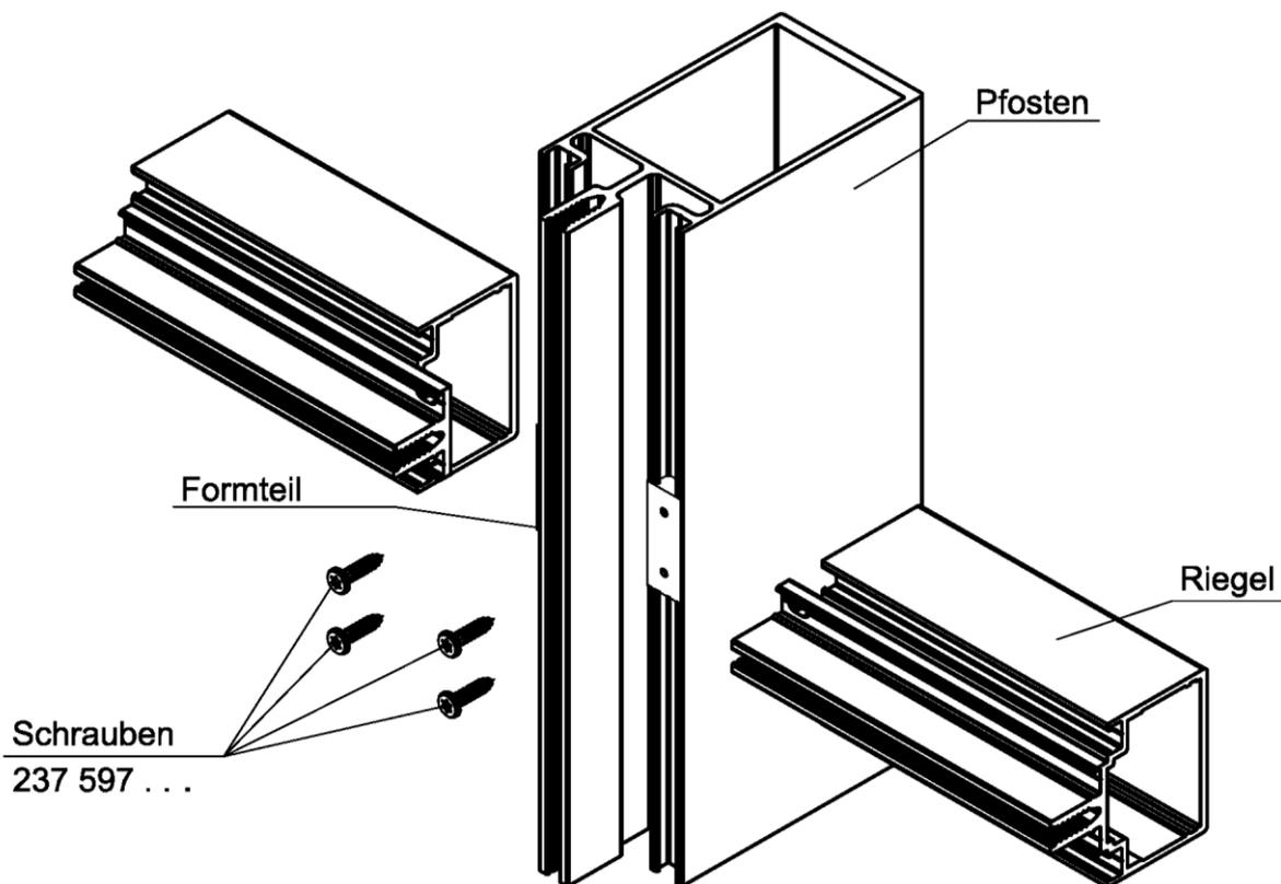
Pfosten-Riegel-Verbindungen (T-Verbindungen) für die Fassadenkonstruktionen AA100 und AA110
