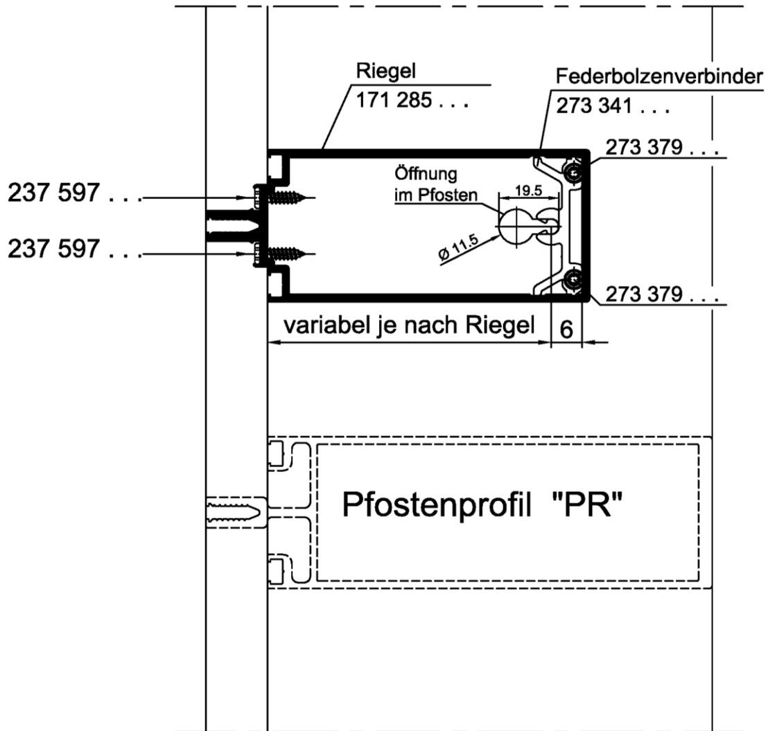
Pfosten-Riegel-Verbindungen (T-Verbindungen) für die Fassadenkonstruktionen AA100 und AA110
