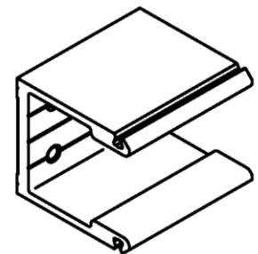
Pfosten-Riegel-Verbindungen (T-Verbindungen) für die Fassadenkonstruktionen AA100 und AA110
