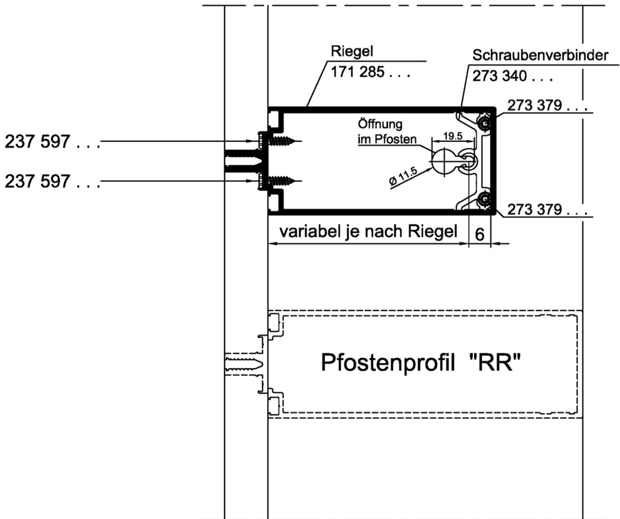
Pfosten-Riegel-Verbindungen (T-Verbindungen) für die Fassadenkonstruktionen AA100 und AA110
