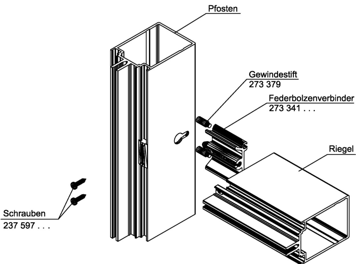
Pfosten-Riegel-Verbindungen (T-Verbindungen) für die Fassadenkonstruktionen AA100 und AA110
