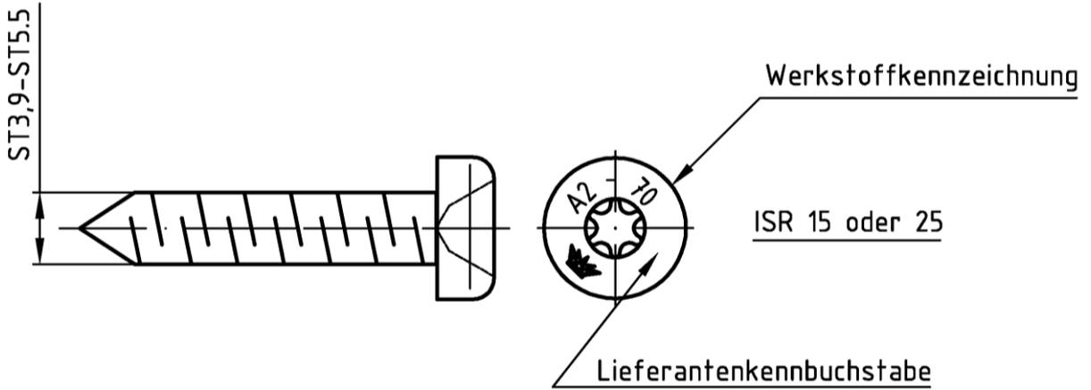
Linsenblechschraube DIN ISO 7049 (DIN 7981) ST3.9-5.5 x 19-25-A2-70
