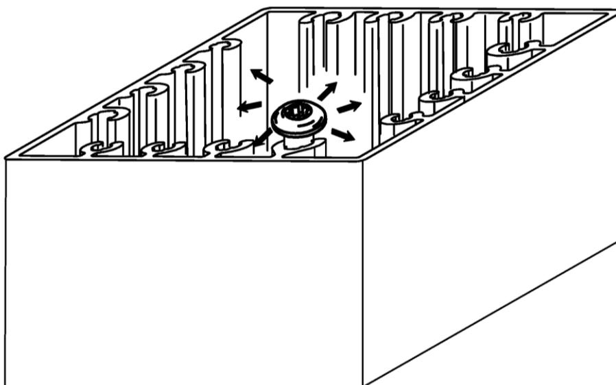
Schraubkanalverbindung für SCHÜCO Systeme
