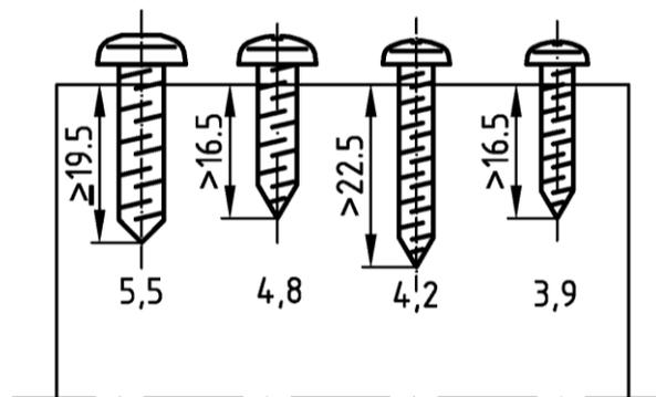
Schraubkanalverbindung für SCHÜCO Systeme
