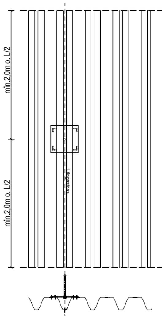
Abbildung 1 - Montagevorgaben auf Trapezprofil (Positivlage)
