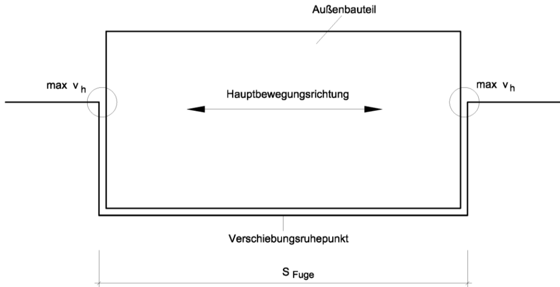
Abb. 48 Einbausituation mit Lagerung an gegenüberliegenden Rändern
