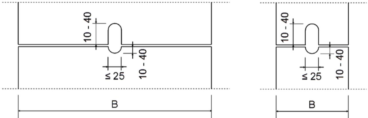
b. Ausführung mit seitlichen Greifnuten und Nut- und Feder
