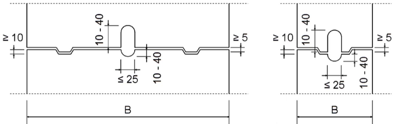
c. Ausführung mit seitlichen Greifnuten und wechselseitiger Nut- und Feder
