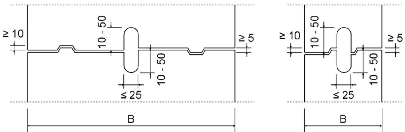
Wandbauart aus Porenbeton-Planelementen
