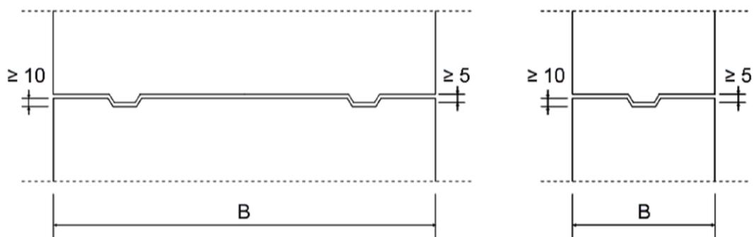
c. Ausführung Stirflächen mit wechselseitiger Nut und Feder
