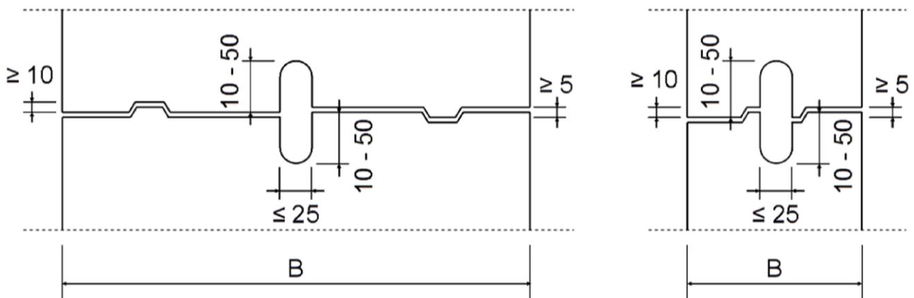
Wandbauart aus Porenbeton-Planelementen
