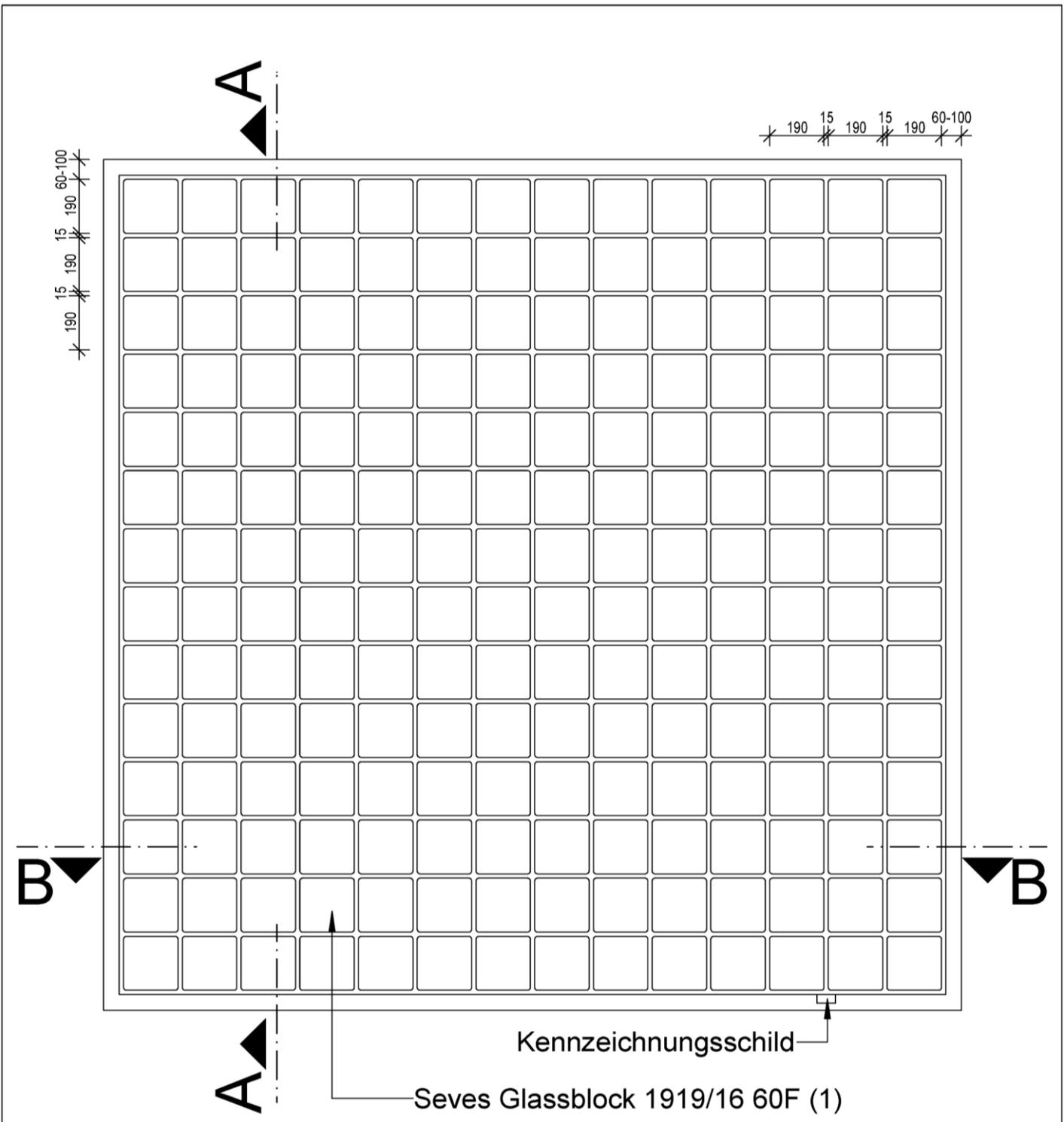
Max. zul. Größe eines Einzelelementes: 9 m<sup>2</sup>
