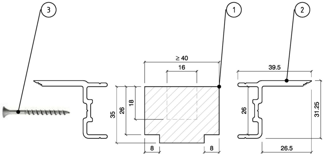
1. Sperrholzprofil, Rohdichte  $\geq 460\text{kg/m}^3$
