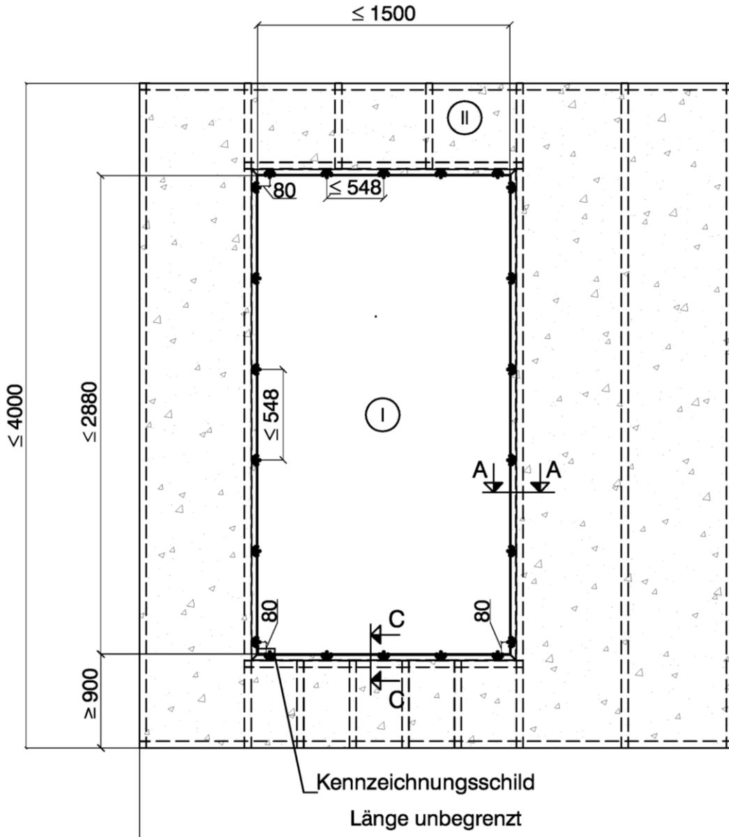
"Planline-Elemente", Nenndicke  $\geq 97\text{mm}$  und  $\leq 200\text{mm}$ "
