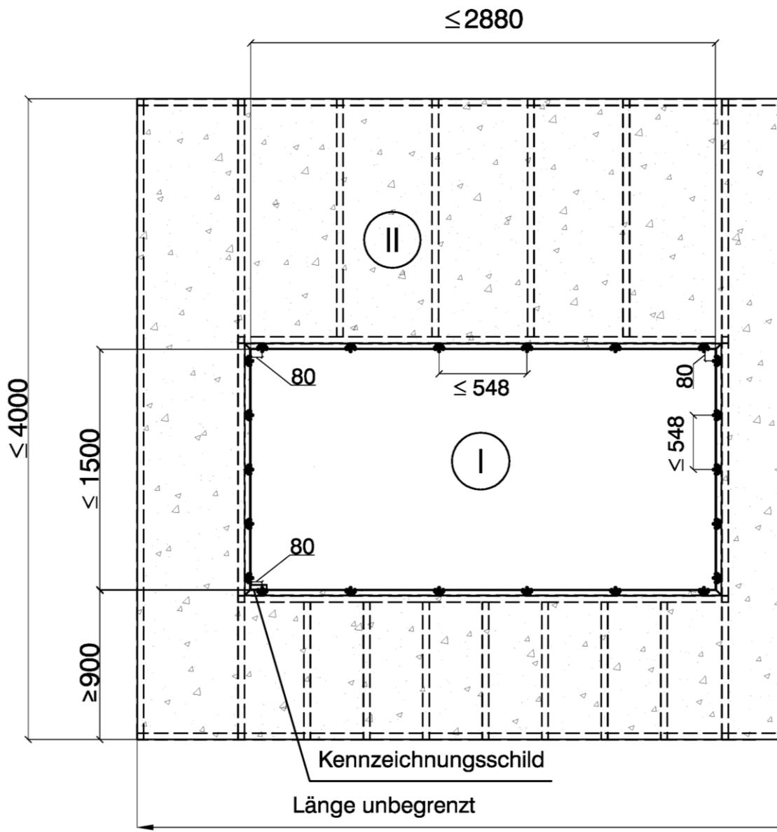
“Planline-Elemente”, Nenndicke  $\geq 97\text{mm}$  und  $\leq 200\text{mm}$ “
