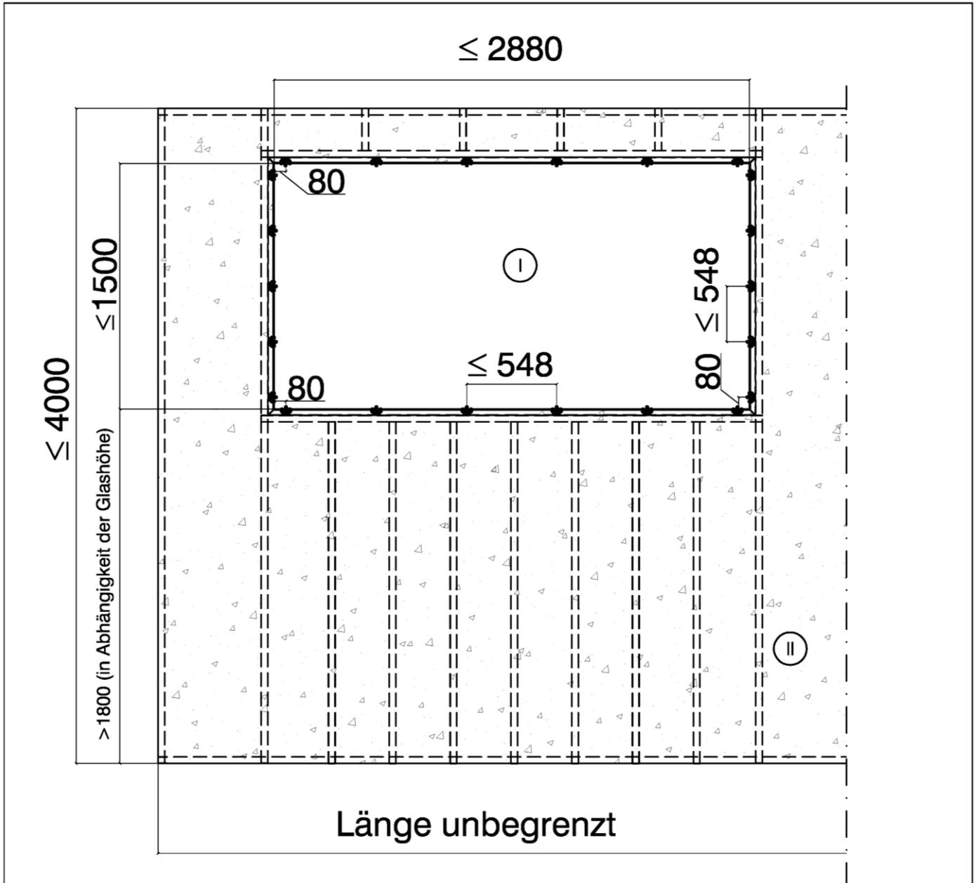
"Planline-Elemente", Nenndicke  $\geq 97\text{mm}$  und  $\leq 200\text{mm}$
