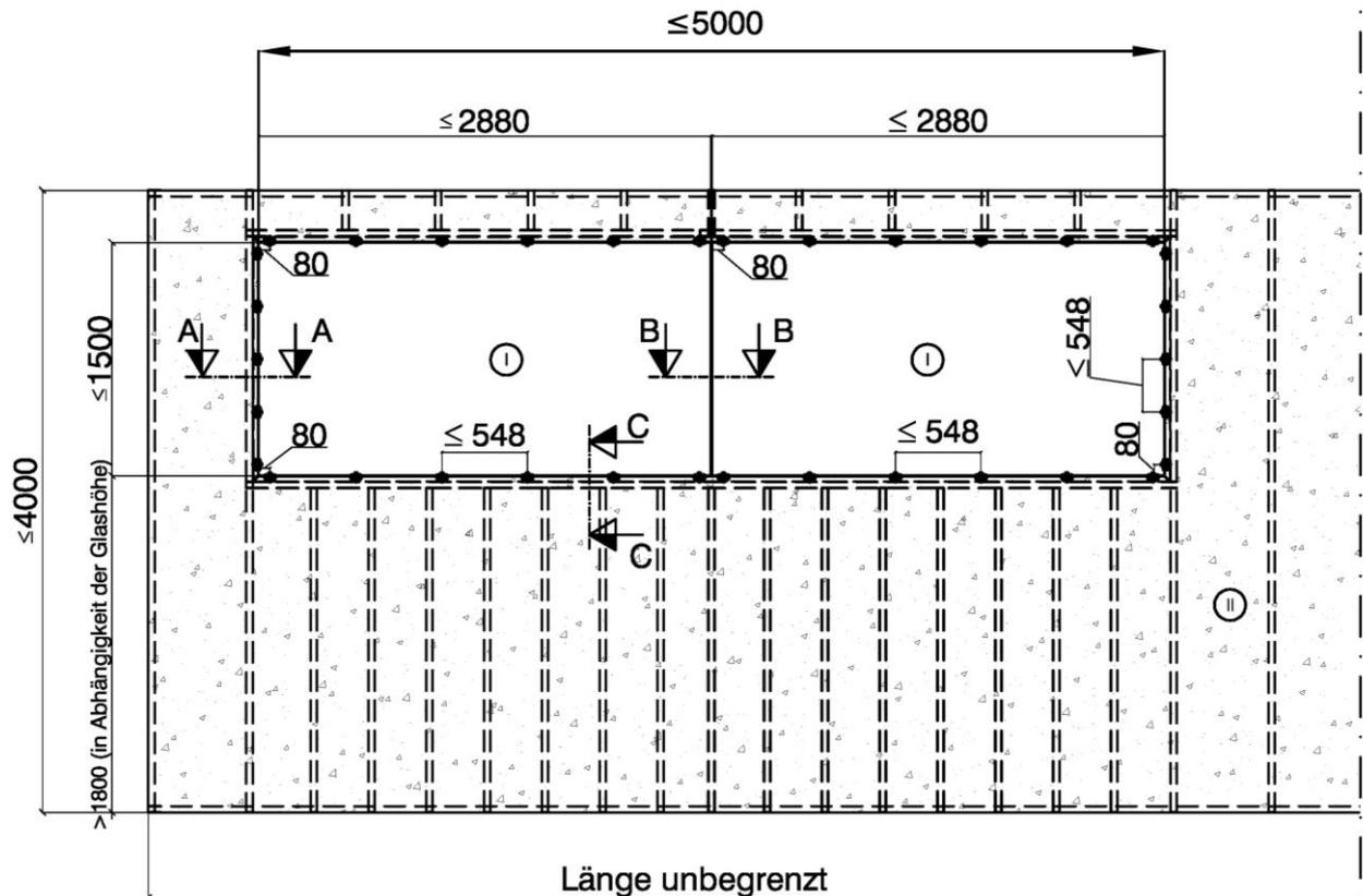
"Planline-Elemente", Nenndicke  $\geq 97\text{mm}$  und  $\leq 200\text{mm}$ ,
