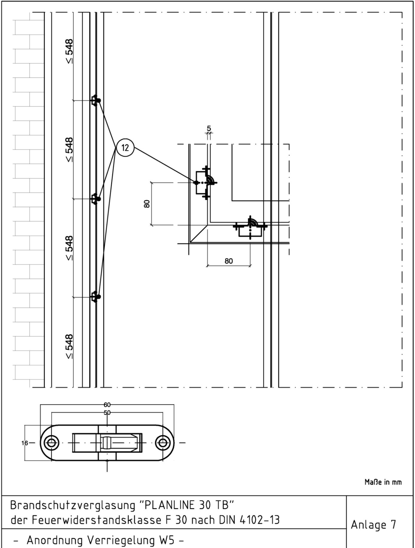
Position Benennung, Werkstoff und Abmessungen
